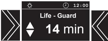
Nach Ablauf der „Life - Guard“ - Zeit wird der IR-Strahler abgeschaltet und die eingestellte „Life - Guard“ - Zeit blinkt
